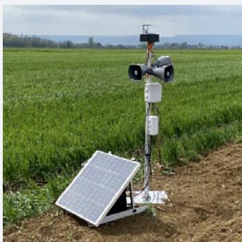
Depuis 2021, Galinios développe un effaroucheur d'oiseaux autonome pour protéger les semis. L'appareil s'installe dès le semis et protège jusqu'à 3ha en autonomie énergétique complète. La machine détecte les oiseaux présents sur la parcelle et émet des sons répulsifs si le nombre d'oiseaux détectés est supérieur à une valeur paramétrable. Le dispositif est capable d'alerter l'exploitant en cas de forte pression aviaire.
